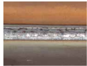
Dia: 1,2 mm Parameter: 361A, V= 28,6 V, vd= 13,5 m/min, vs= 80 cm/min
