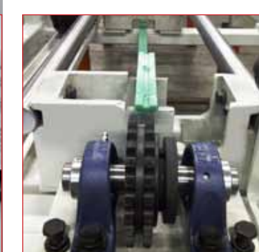
Sistema di guida del carro porta lama Guides du chariot porte-lame Slideways of the blade holder carriage Sistema de guía del carro porta-disco
